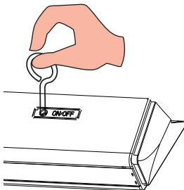
本体下部にあるON/OFFスイッチの穴に付属品の「ON/OFFスイッチ用ピン」を差し込み少し長押しし、点灯させてください。点灯後はピンを抜いてください。
