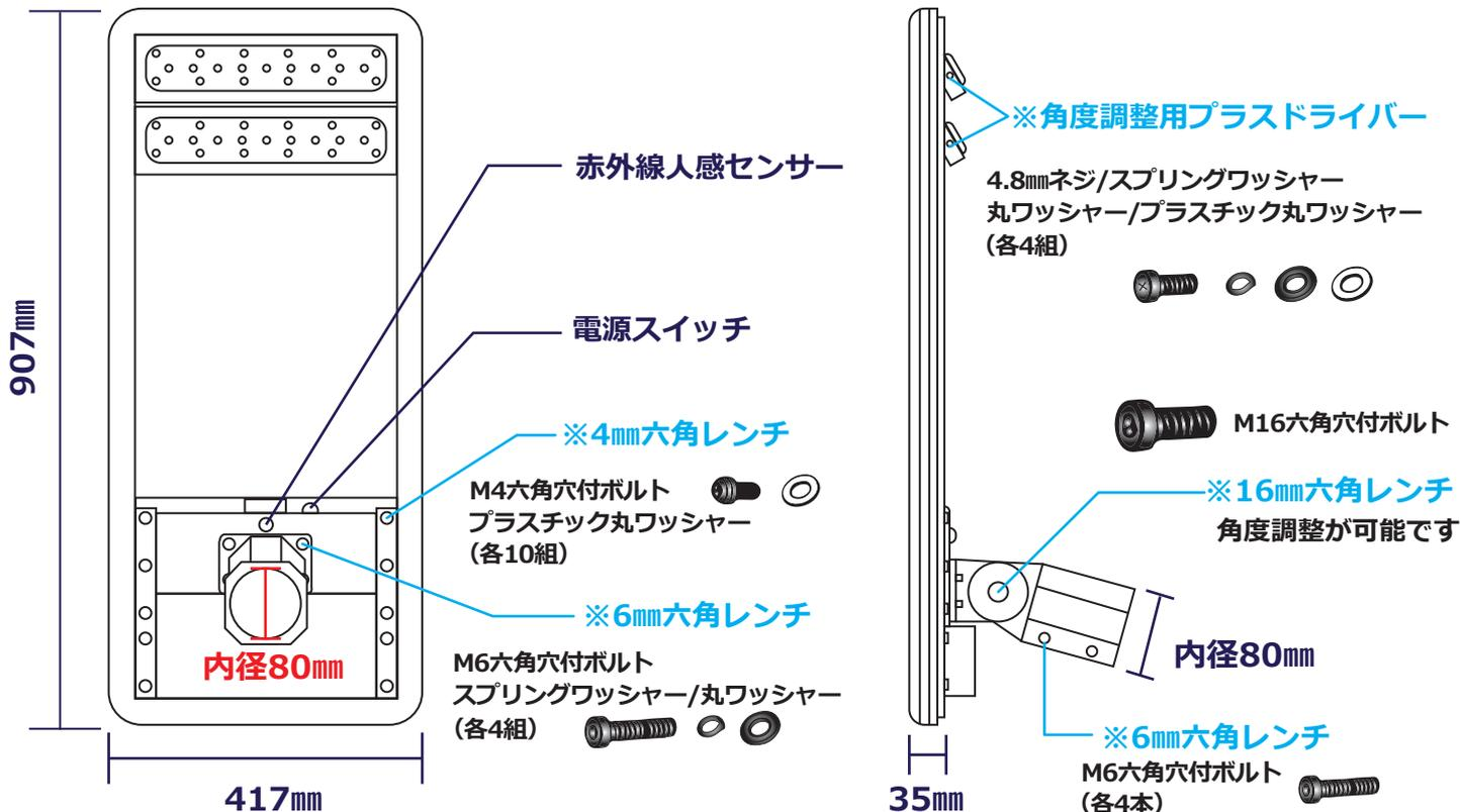
※取付後、全てのネジがしっかりと締められ固定されている事を確認して下さい。
