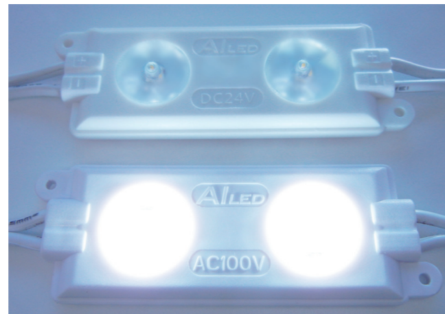
AC100V・DC24V、2.5 w (昼光色 = 6500k、電球色 = 3000k)、照射角 165 度、耐熱性 80℃、耐寒性 - 40℃、IP65 (防水)、推奨看板厚は 50 ~ 150 mm程度。
